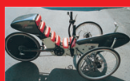
Meisterwerk: vollgefedertes Alu-Chassis, 26"-Räder, anpassbarer Latten-Sitz, Stauraum im Heck
