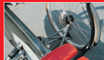
Technik pur: schrägstellende Federbeine, Vorderradkonstruktion, Formula-Scheibenbremsen
